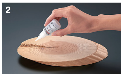
2 木粉を充填した上に、瞬間接着剤を流し込む。
