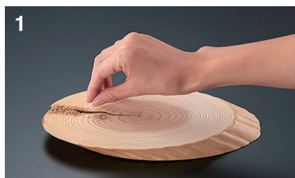
1 木材の割れ、節に同じ材質の木粉を充填する。
