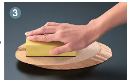
3 硬化を確認後、カンナなどで表面を平らにし、塗装する。
