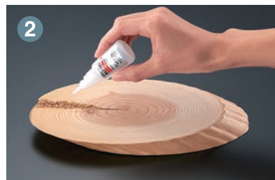
2 木粉を充填した上に、瞬間接着剤を流し込む。
